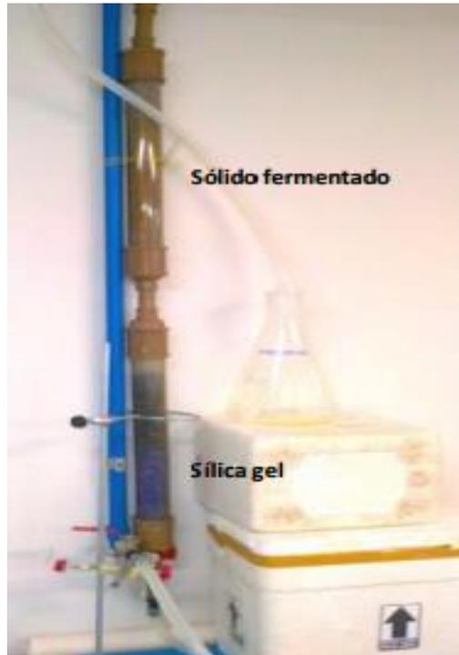
**FIGURA 12.** SISTEMA DE COLUNA COM FLUXO DE AR SECO UTILIZADO PARA SECAGEM DO SÓLIDO FERMENTADO
