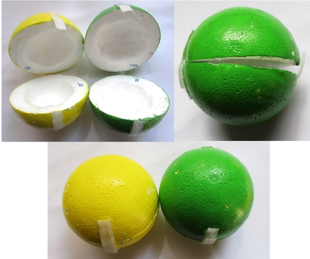
Figura 4 - Bolas de Isopor 80mm, cortadas ao meio, com buraco de aproximadamente 55mm, e com tiras de velcro para que possam ser fechadas. Fonte: Os autores.
