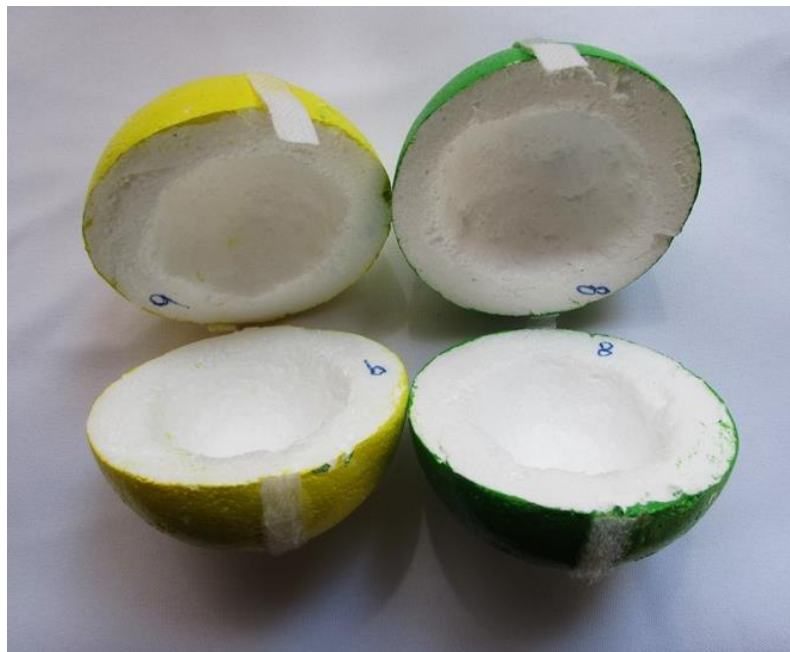
Figura 5 - Bolas de Isopor 80mm, cortadas ao meio, com buraco de aproximadamente 55mm, e com tiras de velcro para que possam ser fechadas. Fonte: Os autores.
