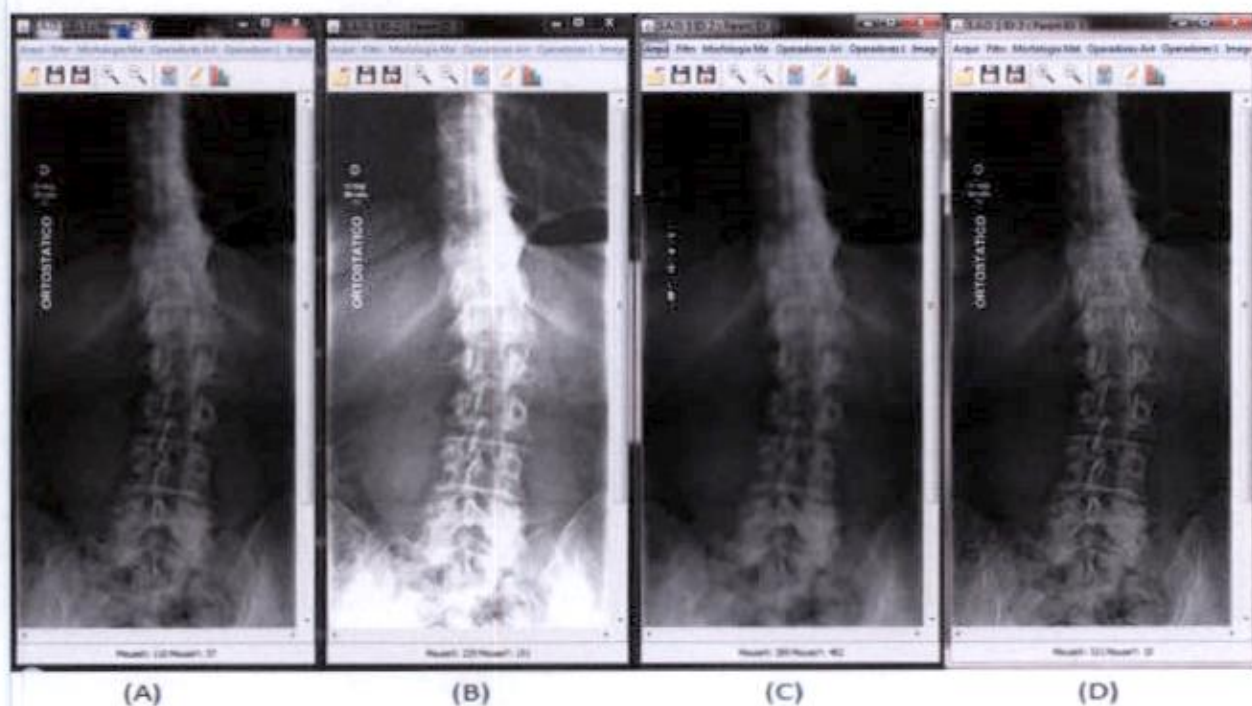
Figura 23 – Demonstração dos filtros de tratamento. (a) – Imagem original, (b) – filtro de brilho e contraste, (c) - Mediana e (d) - Convolução.
