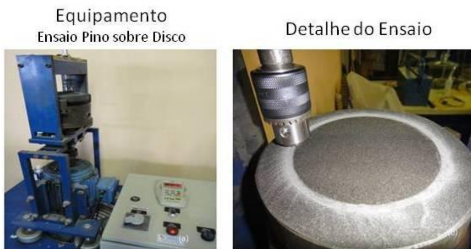
Figura 13 – Fotografia mostrando o equipamento utilizado nos ensaios de desgaste tipo pino sobre disco.
