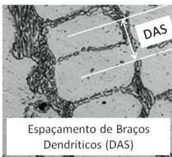
Figura 10 – Esquema mostrando o parâmetro escolhido para avaliar o grau de refino (espaçamento de braços dendríticos ou DAS).
