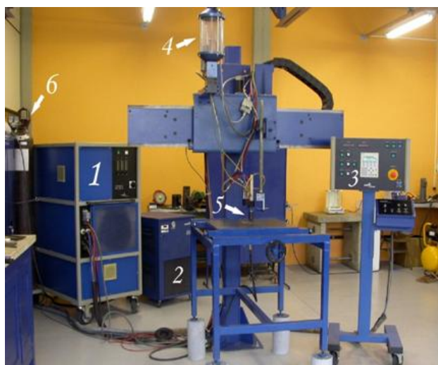
Figura 2 – Componentes do sistema de deposição por PTA: 1 – Fonte de energia ou de soldagem, 2 – Unidade de refrigeração, 3 – Painel de controle, 4 – Reservatório de pós, 5 – Tocha PTA, 6 – Cilindro de gás de argônio
