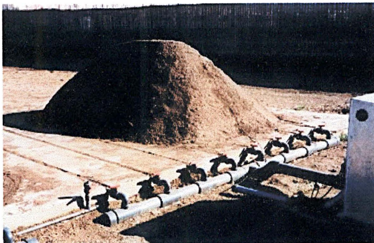
FIGURA 1.2 PILHA ESTÁTICA AERADA [13]
