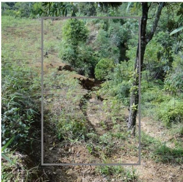
Figura 21 – Trincas superficiais. Fonte: Vogt (2012).
