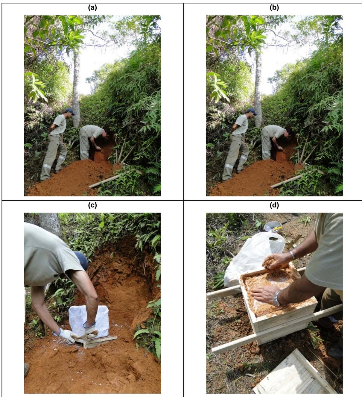
Figura 26 – Coletas de amostras indeformadas. Fonte: Vogt (2012).
