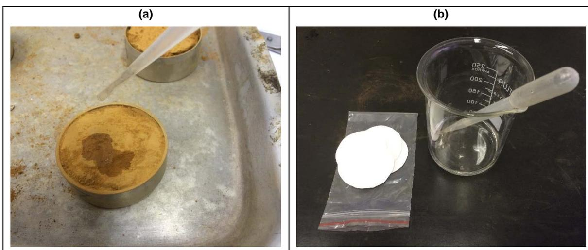
**Figura 31 – Incremento de umidade – ensaio de sucção.**
