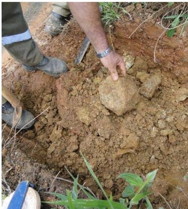
**Figura 27 – Coletas de amostras indeformadas. Fonte: Ufpr (2013).**
