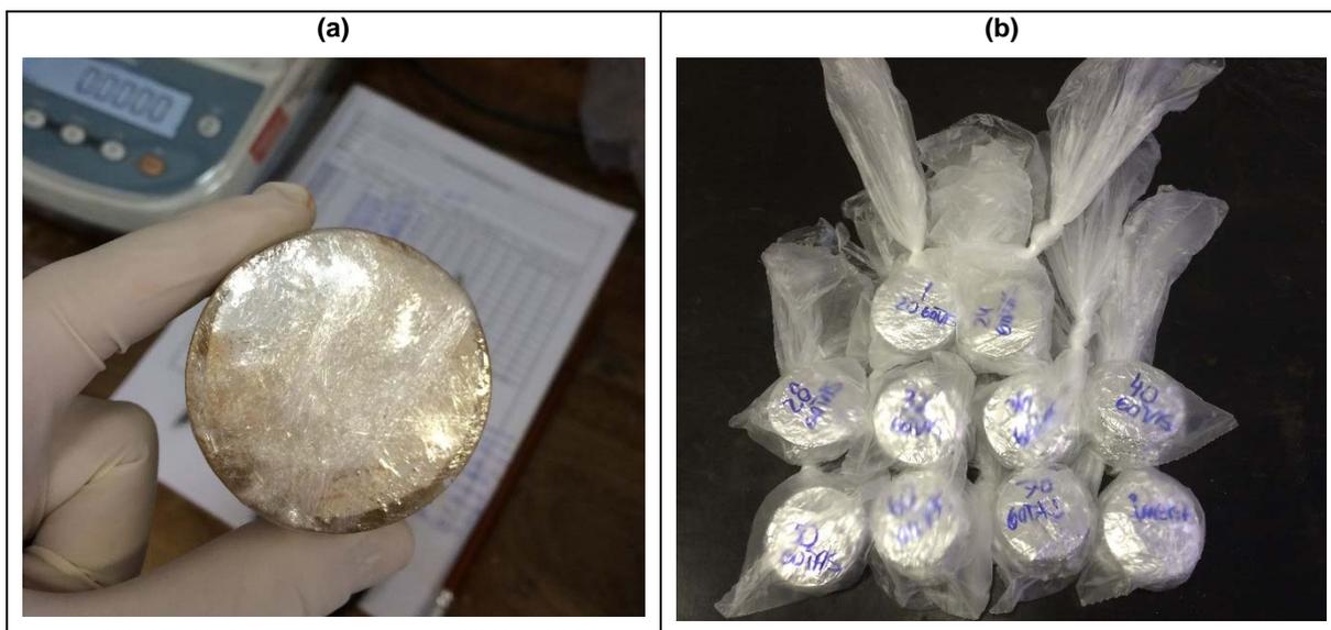
Figura 32 – Corpos de prova – ensaio de sucção.
