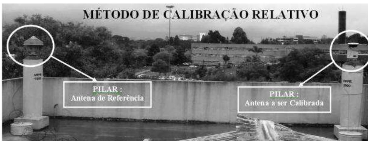
FIGURA 4 – CALIBRAÇÃO RELATIVA EM CAMPO NA BCAL/UFPR
