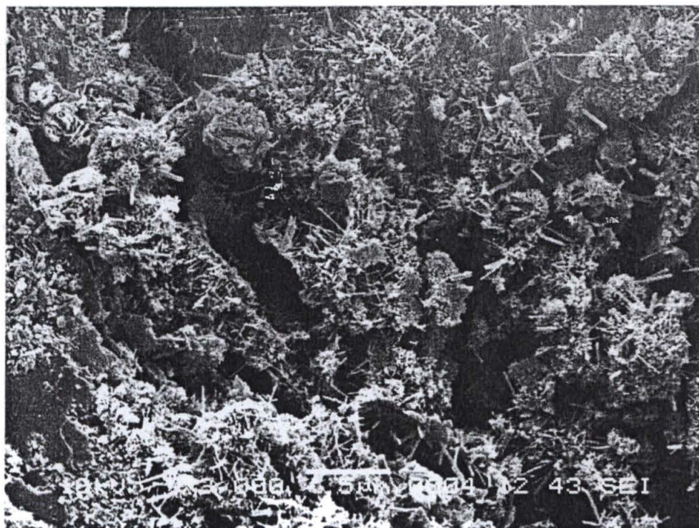
Figura 40. Micrografia para o material endurecido da mistura de areia e cimento (Base) com magnificação de 3000X.
