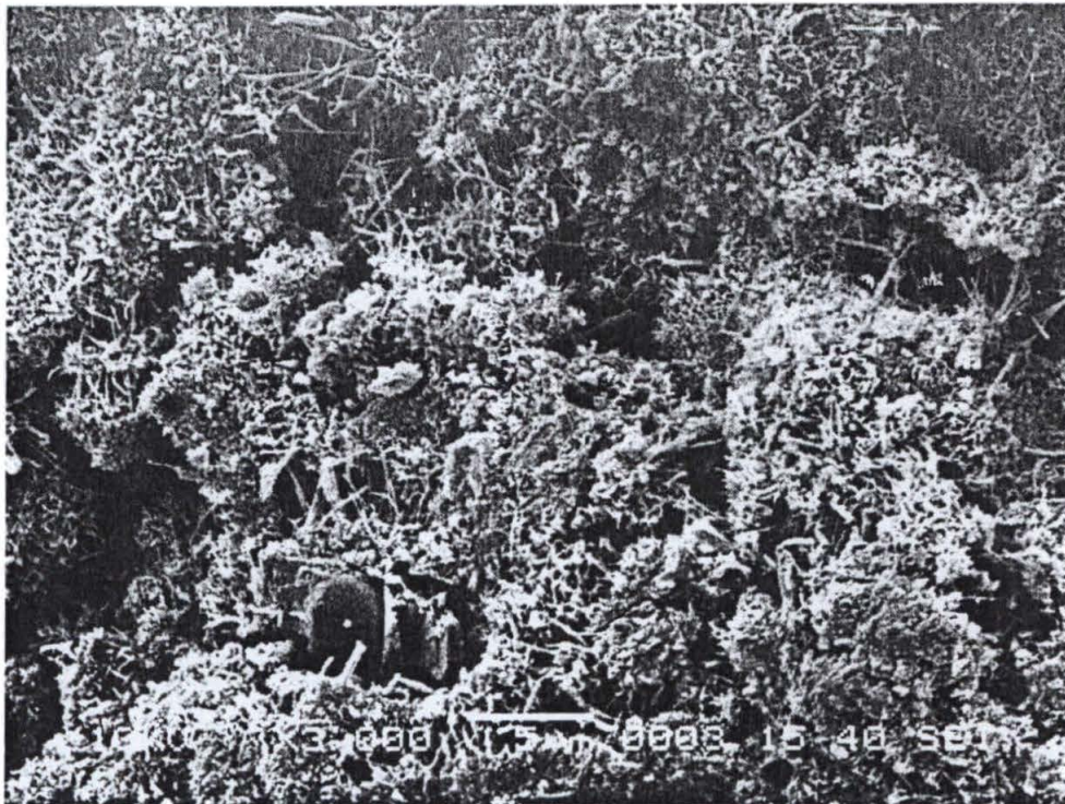
Figura 42. Micrografia para o material endurecido da mistura de areia e cimento (Base) com adição dos complexos CMC-093-Fe em magnificação de 3000X.
