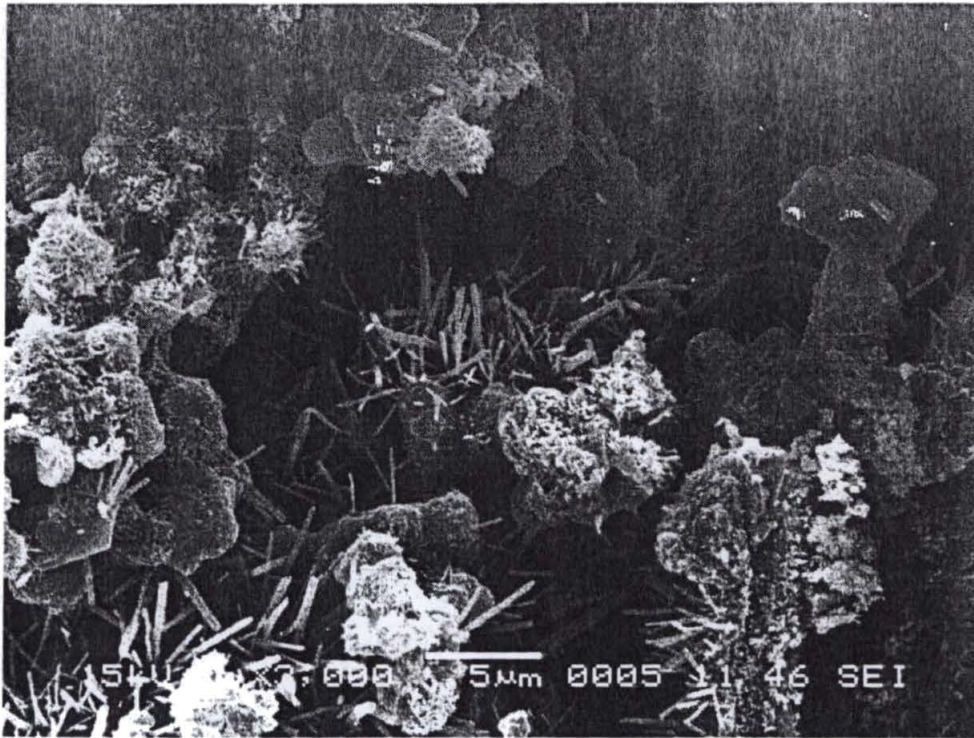
Figura 45. Micrografia para o material endurecido da mistura de areia e cimento (Base) com adição dos complexos CMC-092-Fe em magnificação de 3000X.
