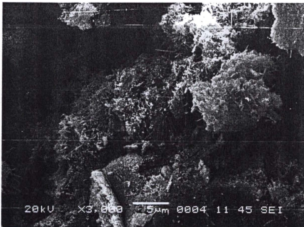
Figura 46. Micrografia para o material endurecido da mistura de areia e cimento (Base) com adição dos íons \text{Fe}^{3+} em magnificação de 3000X.
