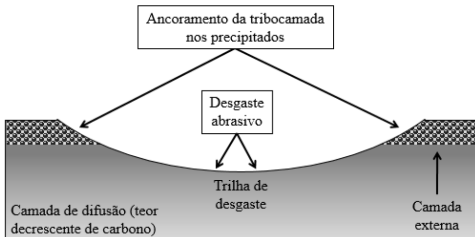
Figura 73. Modelo proposto para explicar a formação da tribocamada segmentada verificada para a condição de tratamento \text{VTO}_{400-48} .
