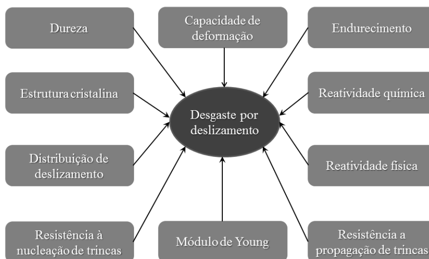
Figura 87. Propriedades metalúrgicas que influenciam o desgaste por deslizamento (ZUN GAHR, 1987).
