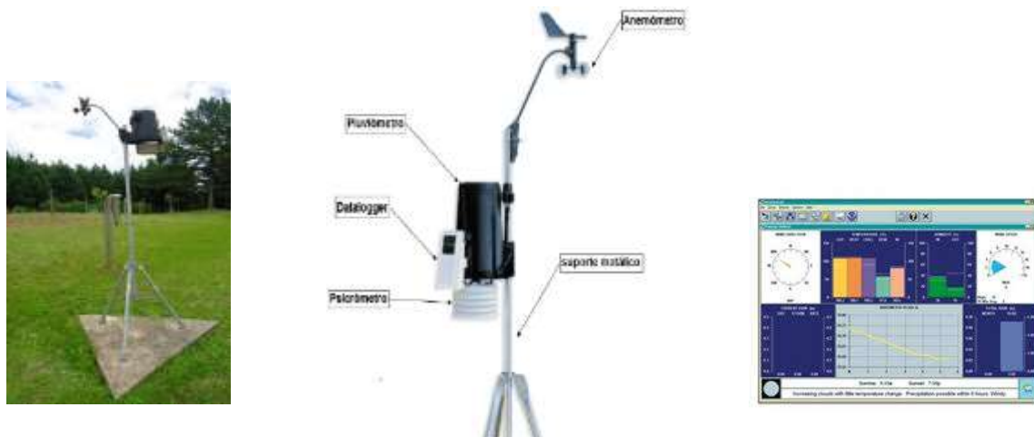
FIGURA 7 - ESTAÇÃO METEOROLÓGICA AUTOMÁTICA DAVIS VANTAGE PRO2 FONTE: Adaptado de FRANÇA (2012)
