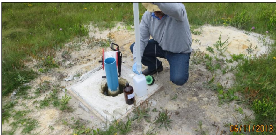
FIGURA 17 – COLETA DE AMOSTRA DE ÁGUA SUBTERRÂNEA REALIZADA COM BAILER DESCARTÁVEL E ACONDICIONAMENTO NOS FRASCOS FORNECIDOS PELO LPH DEPOIS DE REALIZADA AMBIENTAÇÃO.
