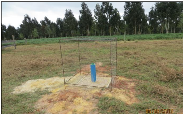
FIGURA 11 – POÇO DE MONITORAMENTO DA QUALIDADE DA ÁGUA SUBTERRÂNEA PM01. 20,80 METROS DE PROFUNDIDADE. LOCALIZAÇÃO UTM: W 595940; S 7221019. (DATUM SAD69)
