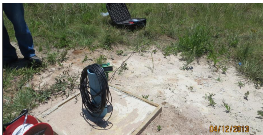
FIGURA 23 – MEDIÇÃO DE CAMPO UTILIZANDO A SONDA MULTIPARÂMETRO AQUAREAD AP 700 PARA TEMPERATURA, PH E ORP. FONTE: Autor (2013).
