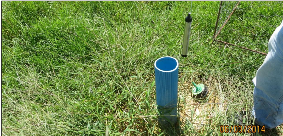
FIGURA 20 - MEDIDOR DE NÍVEL MODELO EDGE , MARCA SOLINST ® , UTILIZADO NA CARACTERIZAÇÃO DO COMPORTAMENTO DO NÍVEL HIDROSTÁTICO AO LONGO DO TEMPO DURANTE UM PERÍODO DE 27 DIAS NO PM02 E 28 DIAS NO PM03.
