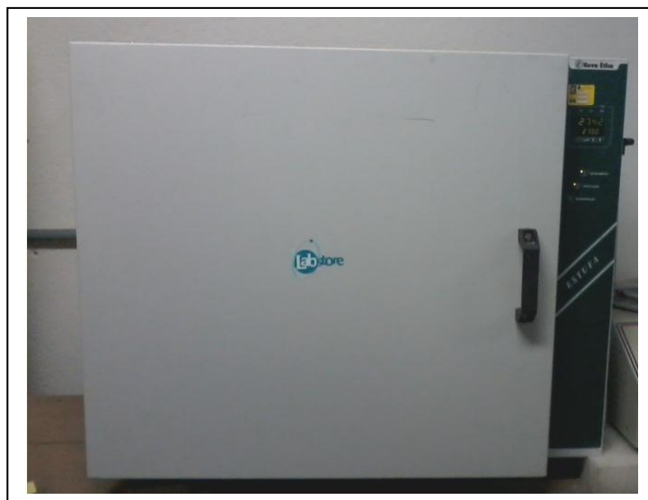
FIGURA 22 – FORNO UTILIZADO PARA O AQUECIMENTO DOS CORPOS DE PROVA FONTE: O autor
