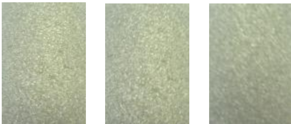
FIGURA 28 - AMOSTRAS ASPERGIDAS COM DISTÂNCIAS DE 100 MM, 150 MM E 250 MM, RESPECTIVAMENTE, APÓS O ENSAIO DE DOBRAMENTO FONTE: O autor
