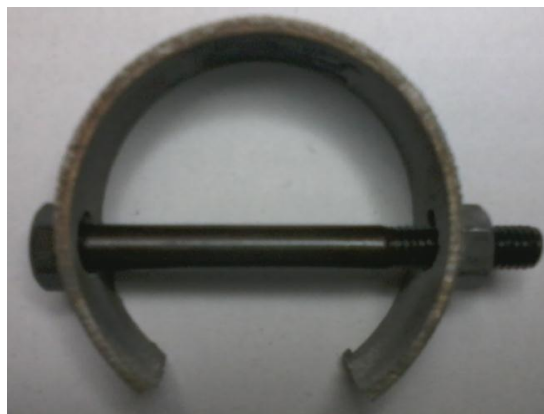
FIGURA 30 – CORPO DE PROVA APÓS O TENSIONAMENTO FONTE: O autor
