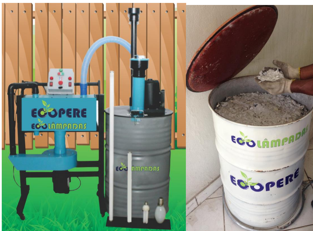
Figuras 05 e 06 – Triturador de lâmpadas fluorescentes e tambor de 200L com resíduos descontaminados (vidro e alumínio). Fonte: Acervo pessoal. Março/2014.
