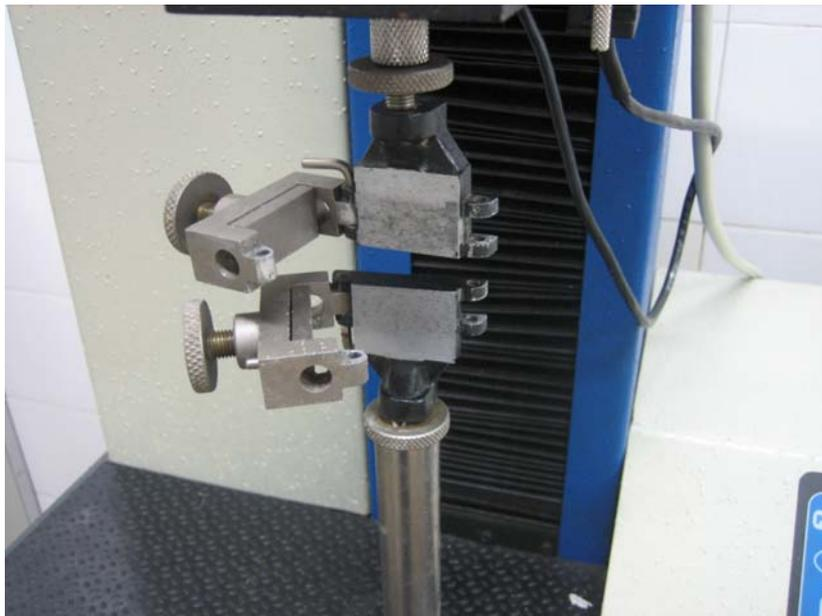
Cada segmento venoso foi aberto no seu sentido longitudinal, e as extremidades laterais foram fixadas às presilhas da aparelhagem para medição. A máquina realiza a tração do tecido analisado, registrando num gráfico a curva força versus deslocamento, e proporcionando os valores máximos suportados pela veia, em quilogramas-força (kgf).
