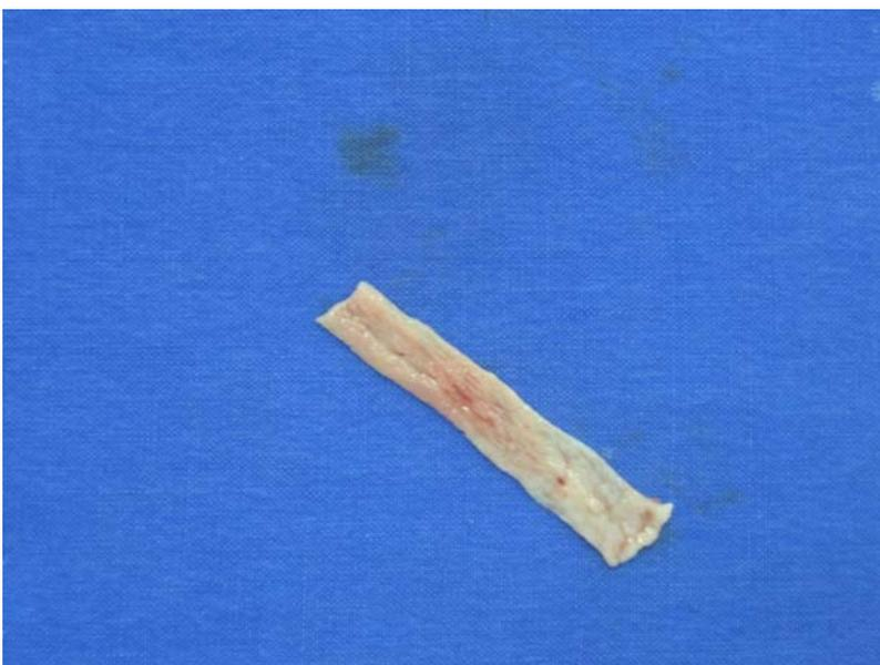
FIGURA 7 - VEIA SAFENA MAGNA ABERTA EM SEU SENTIDO LONGITUDINAL, COLOCADA NAS GARRAS DE PREENSÃO, PRONTA PARA O INÍCIO DO ENSAIO DE TRAÇÃO
