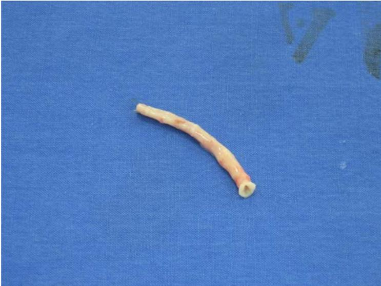
FIGURA 6 - VEIA SAFENA MAGNA ABERTA EM SEU SENTIDO LONGITUDINAL, PRONTA PARA SER COLOCADA NAS GARRAS DE PREENSÃO DA MÁQUINA DE ENSAIO
