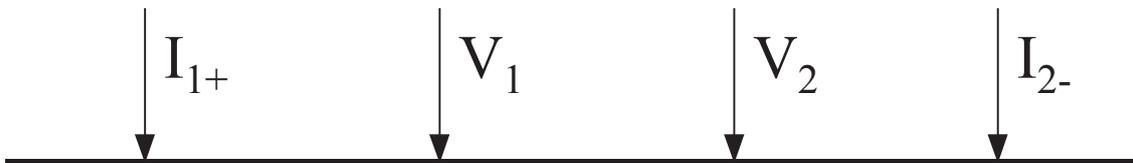
**Figura 2.2 – Configuração de eletrodos para análise da resistividade do solo**
