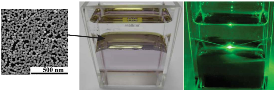
Figura 32. Filme de nanopartículas de ouro em interface líquido-líquido para aplicações óticas. [131]
