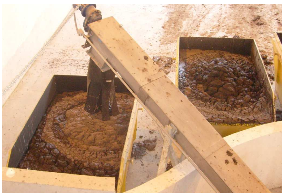
FIGURA 13 - LODO APÓS MISTURADOR MECÂNICO DE CAL, UGL BELÉM, CURITIBA, PR FONTE: O autor (2011)
