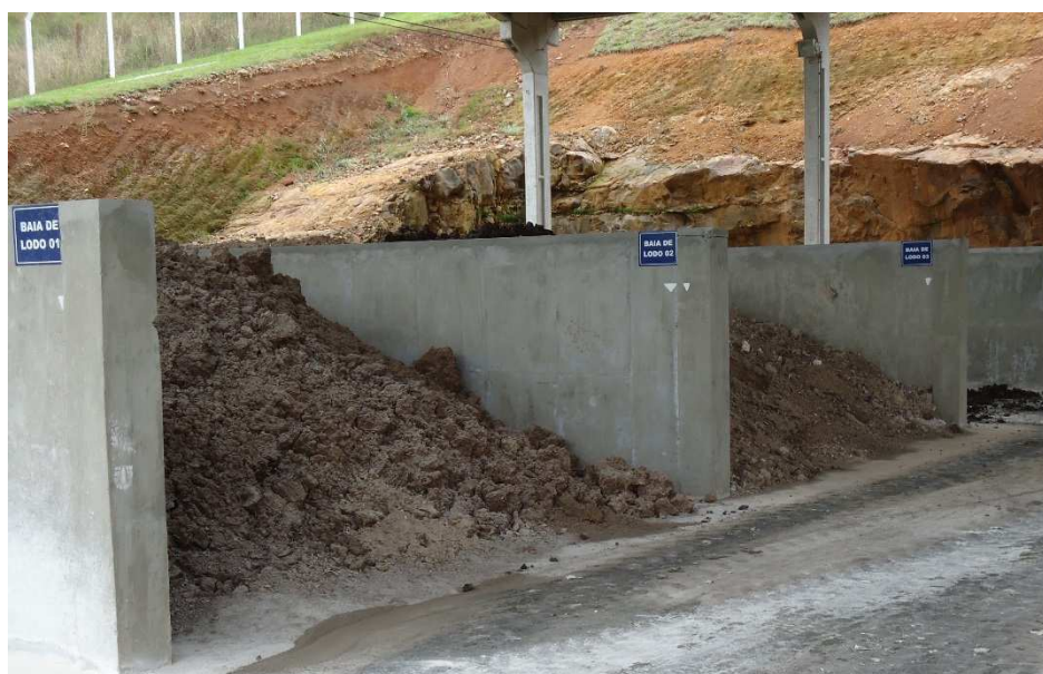
FIGURA 14 - LODO HIGIENIZADO COM CAL ARMAZENADO EM PÁTIO PARA CURA, UGL VASSOURAL, GUARAPUAVA, PR FONTE: O autor (2012)
