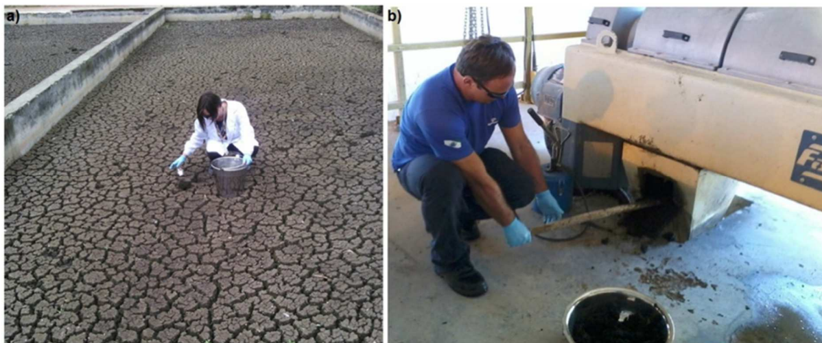
FIGURA 4 - LOCAIS DE AMOSTRAGEM DE LODO DESAGUADO EM ETEs DA RMC. a) EM SISTEMAS DE DESAGUAMENTO EM LEITOS DE SECAGEM. b) EM SISTEMAS COM CENTRÍFUGA
