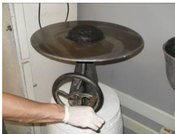
Figura 19 - Determinação da consistência usando a mesa de espalhamento conforme NBR 7215 (ABNT, 1996). Fonte: Própria.
