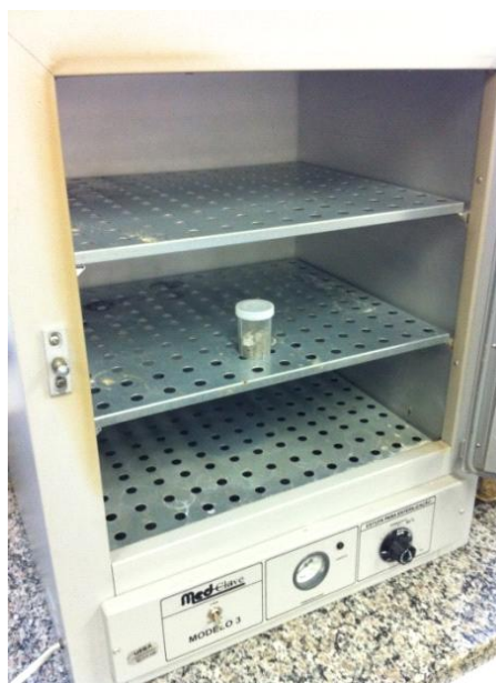
Figura 21 - Ilustração da cura das pastas para a DRX. Fonte: Própria.
