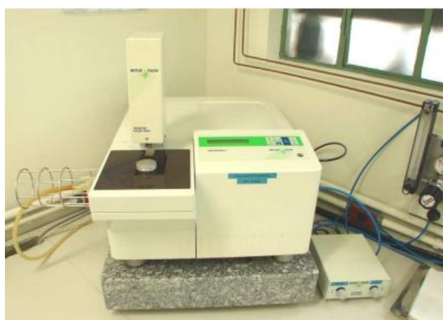
Figura 16 - Equipamento de análise termogravimétrica e termogravimétrica. Fonte: Própria.
