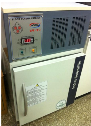
Figura 22 - Freezer utilizado para congelar as amostras à -30 °C. Fonte: Própria.
