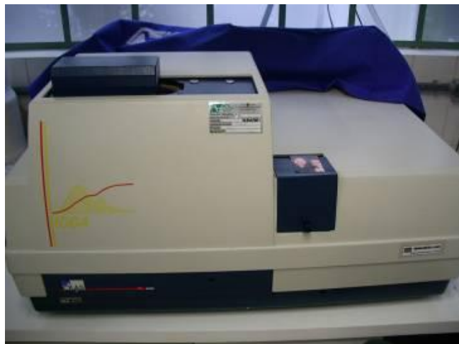
Figura 12 - Granulômetro a laser CILAS 1064. Fonte: Própria.
