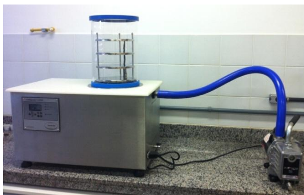
Figura 23 - Liofilizador empregado. Fonte: Própria.
