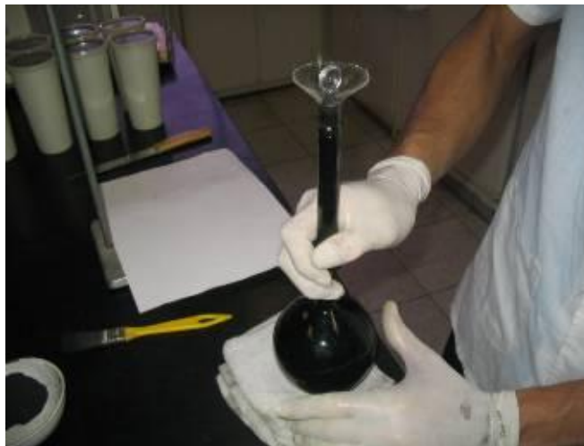
Figura 11 - Execução do ensaio de massa específica. Fonte: Própria.
