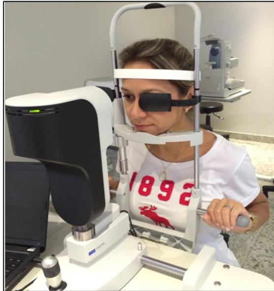
**FIGURA 9 – BIÔMETRO POR INTERFEROMETRIA ÓPTICA.**
