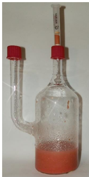
FIGURA 13 - SISTEMA DE PURG-AND-TRAPE UTILIZADO PARA A EXTRAÇÃO DE COMPOSTOS ODORÍFEROS NESTE TRABALHO
