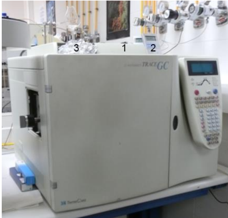
FIGURA 6 – CROMATÓGRAFO EM FASE GASOSA (1) INJETOR; (2) CRONÓMETRO; (3) SNIFFING PORT – ODO FONTE: O autor (2012)
