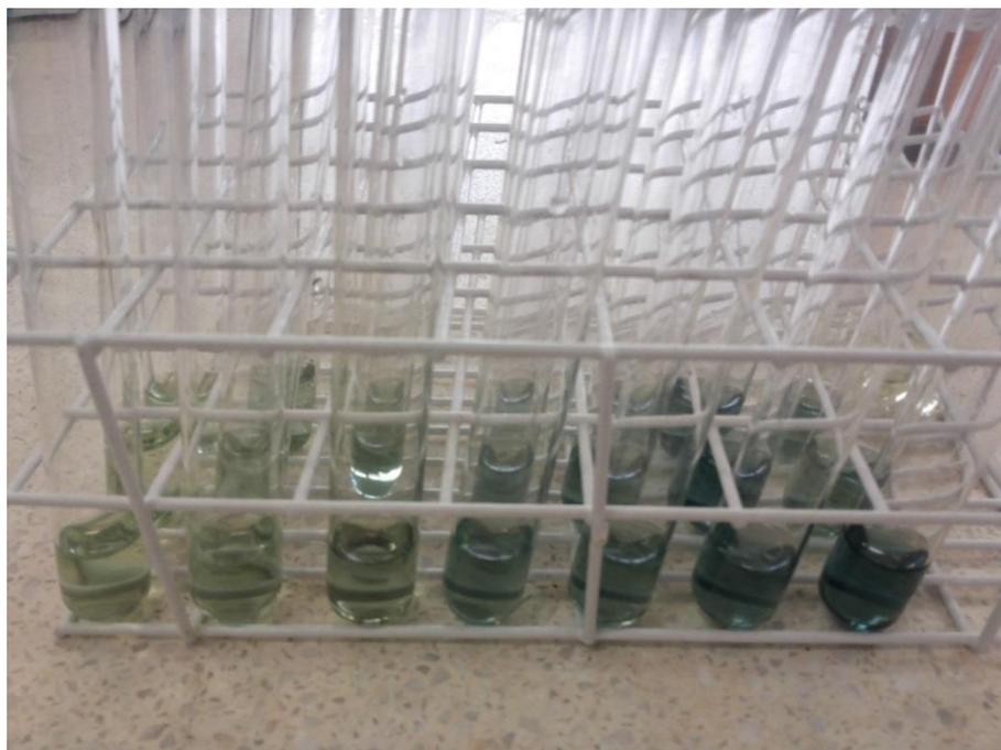
FIGURA 19 – CONCENTRAÇÕES UTILIZADAS PARA O ESTABELECIMENTO DA CURVA PADRÃO DE ÁCIDO GÁLICO PARA O DOSEAMENTO DE COMPOSTOS FENÓLICOS.
