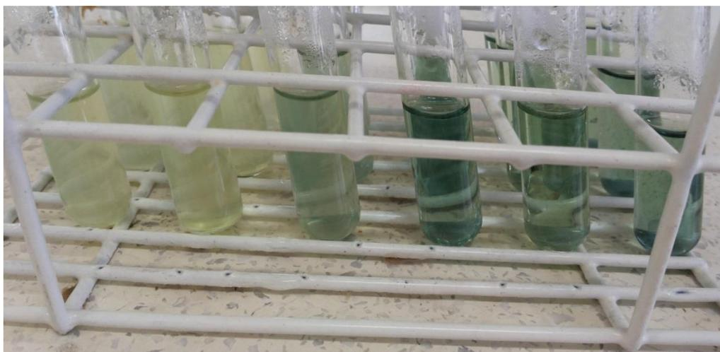
FIGURA 21 – REAÇÃO DE COMPLEXAÇÃO DO FOSFOMOLIBDÊNIO.
