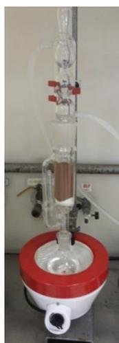
FIGURA 15 – APARELHO SOXHLET PARA OBTENÇÃO DOS EXTRATOS.
