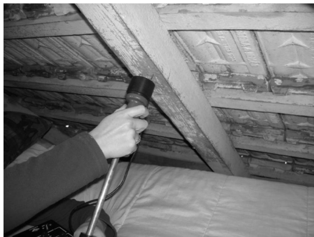
FIGURA 85 – EQUIPAMENTO MEDIDOR DE UMIDADE COM SONDA DE PENETRAÇÃO.
