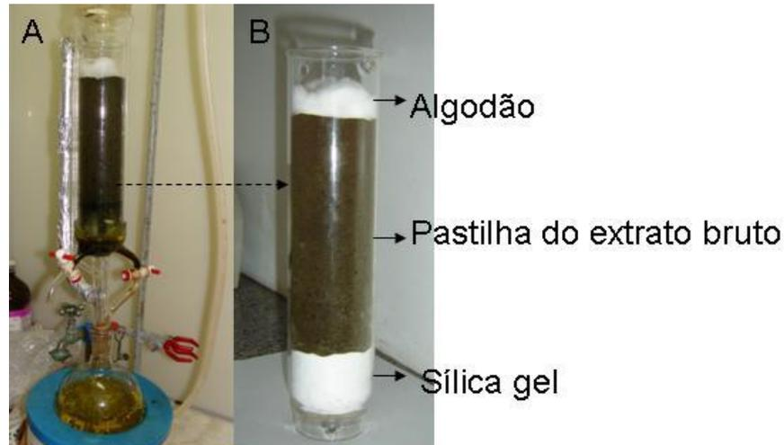
FIGURA 7 - SISTEMA DE PARTIÇÃO SÓLIDO-LÍQUIDO
