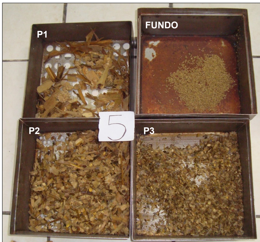
FIGURA 4 - FRAÇÕES DAS SOBRAS DA DIETA DE TOURINHOS PURUNÃ OBTIDAS NAS PENEIRAS COM ABERTURAS DE 19 mm (P1), 7,8 mm (P2), 1,7 mm (P3) DE DIÂMETRO E NO COMPARTIMENTO FECHADO (FUNDO)
