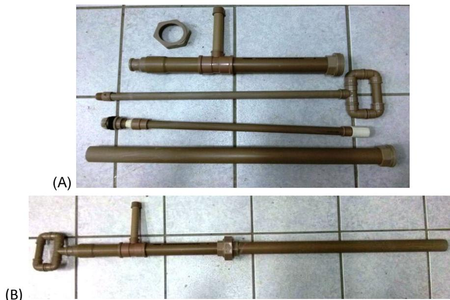
Figura 13: Testemunhador de PVC desmontado (A) e pronto para o uso (B)
