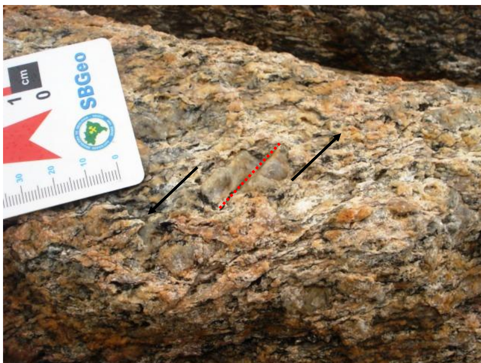
FIGURA 59 – Fragmento escalonado sintético de feldspato potássico, designando movimentação sinistral para a foliação S_{n+1} .
