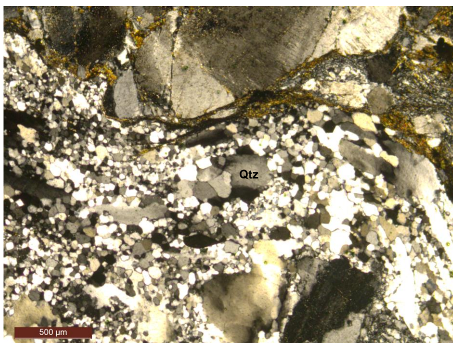
FIGURA 66 – Fotomicrografia do granito protomilonítico da ilha do Norte (Tamboretetes). Níveis compostos por subgrãos e novos grãos de quartzo levemente ondulados (LPC, lâmina MTB – 26). LEGENDA: Qtz – quartzo.
