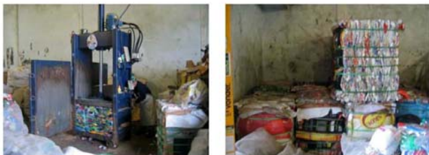
Figura 5-9: Prensa do material reciclável separado para venda. Figura 5-10: Armazenamento dos fardos, separado para venda.
