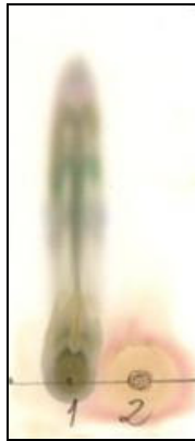
FIGURA 35: cromatoplaça (eluída em \text{CHCl}_3/\text{AcOEt} 8:2 e revelada com sulfato cérico) correspondente às frações orgânica (1) e aquosa (2) de Amansia sp.
