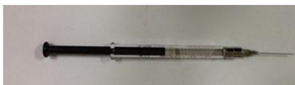
Figura 10 - Seringa Hamilton (Modelo #1002) com agulha de 0,5 mm.
