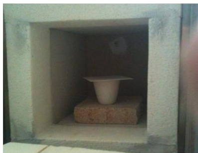
Figura 13 – Recipientes de cerâmica como porta amostras nos tratamentos térmicos.
