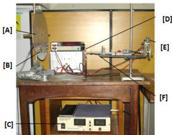
Figura 9 - Montagem experimental para o electrospinning .
