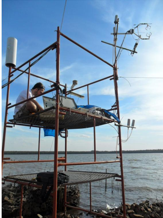
Figura 5.5: Estação micrometeorológica instalada na ilha do reservatório de Itaipu nas proximidades da cidade de Missal.
