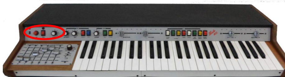
Figura 10 - Painel com switch de liga/desliga, fusível, seletor de tensão e afinador.
