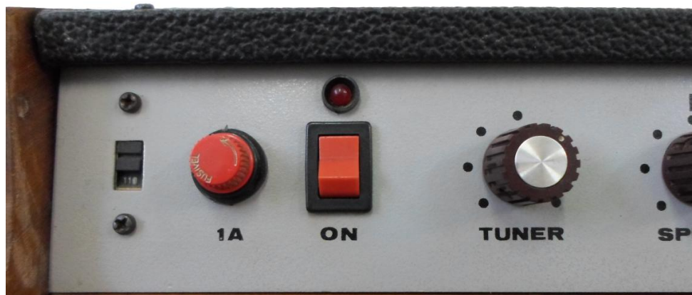
Figura 10 - Painel com switch de liga/desliga, fusível, seletor de tensão e afinador.
