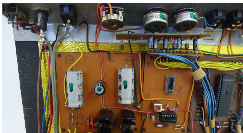
Figura 11 - Localização das chaves de liga/desliga, seletor de tensão, fusível e afinador.
