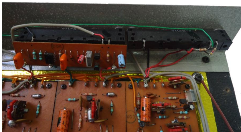
Figura 9 - Controles de volume, vista interna.
