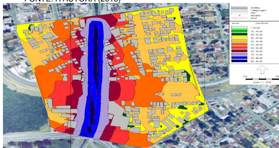
FIGURA 30 - RESULTADO DA SIMULAÇÃO COMPUTACIONAL COM 10% DO TRÁFEGO DE VEÍCULOS PESADOS FONTE: A AUTORA (2013)
