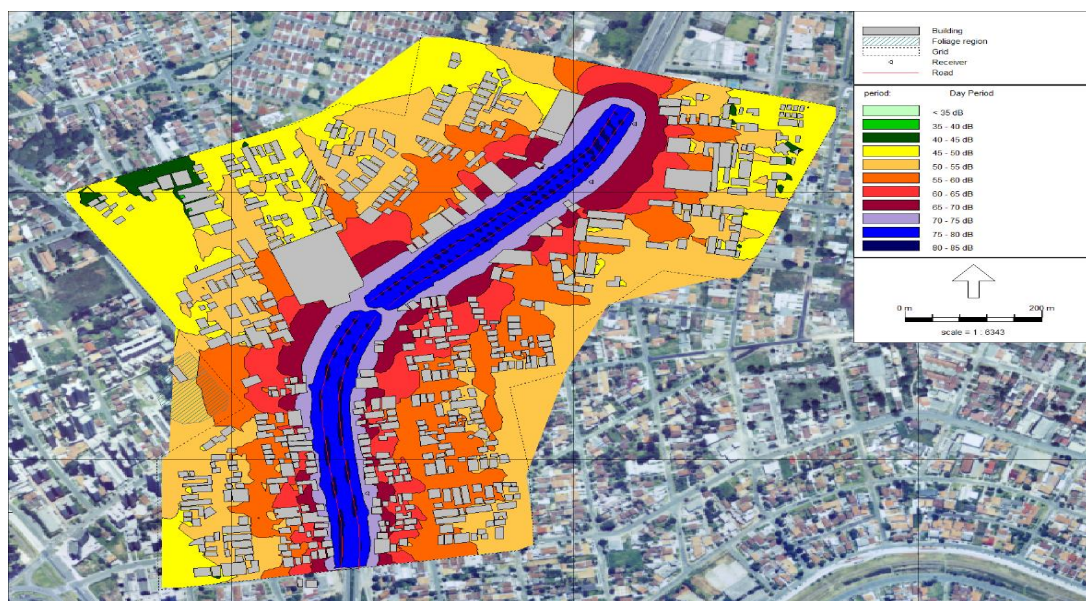
APÊNDICE 8 - MAPA DE RUIDO COM REDUÇÃO DA VELOCIDADE DO TRÁFEGO PARA O LOTE 2 FONTE: A AUTORA, (2013)
