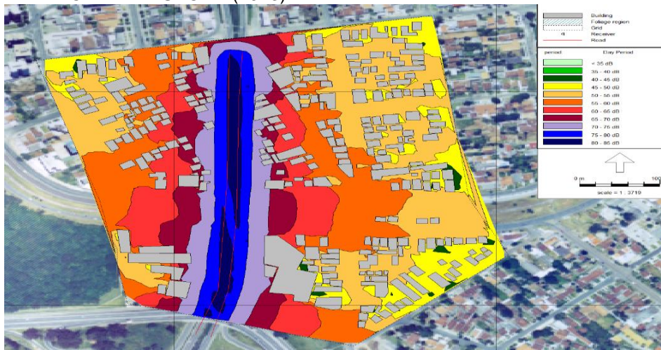
FIGURA 29 - RESULTADO DA SIMULAÇÃO COMPUTACIONAL COM 20% DO TRÁFEGO DE VEÍCULOS PESADOS FONTE: A AUTORA (2013)
