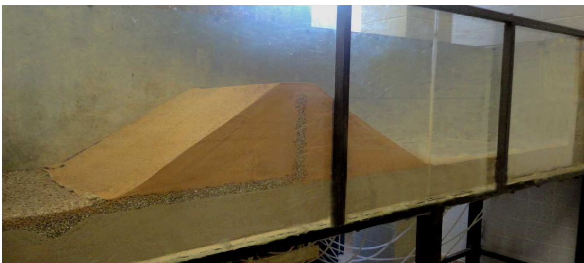
Figura 4.11 – Modelo físico da barragem em estudo
