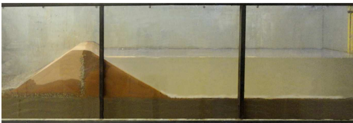
Figura 4.12 – Enchimento do reservatório e estabilização do fluxo
