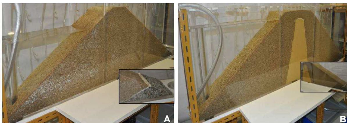
Figura 2.6 – Modelos reduzidos de (MARQUES E UNAS, 2010): (A) Barragem homogênea com dreno de pé de talude, e; (B) Barragem com núcleo de baixa permeabilidade
