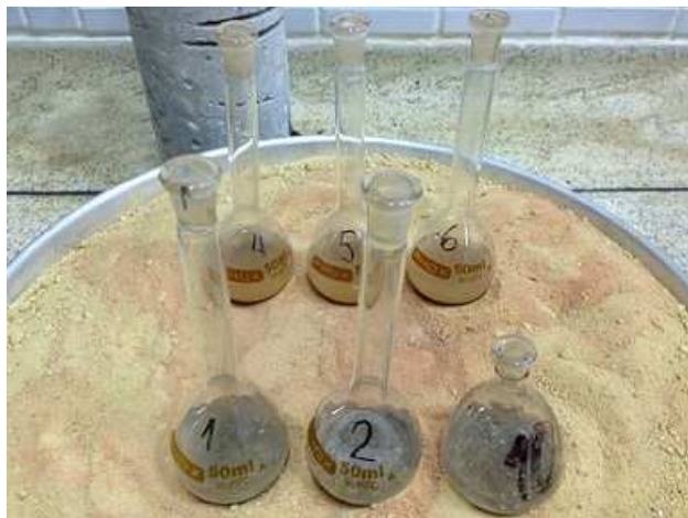
Figura 4.3 – Ensaio de determinação da densidade real das partículas sólidas
