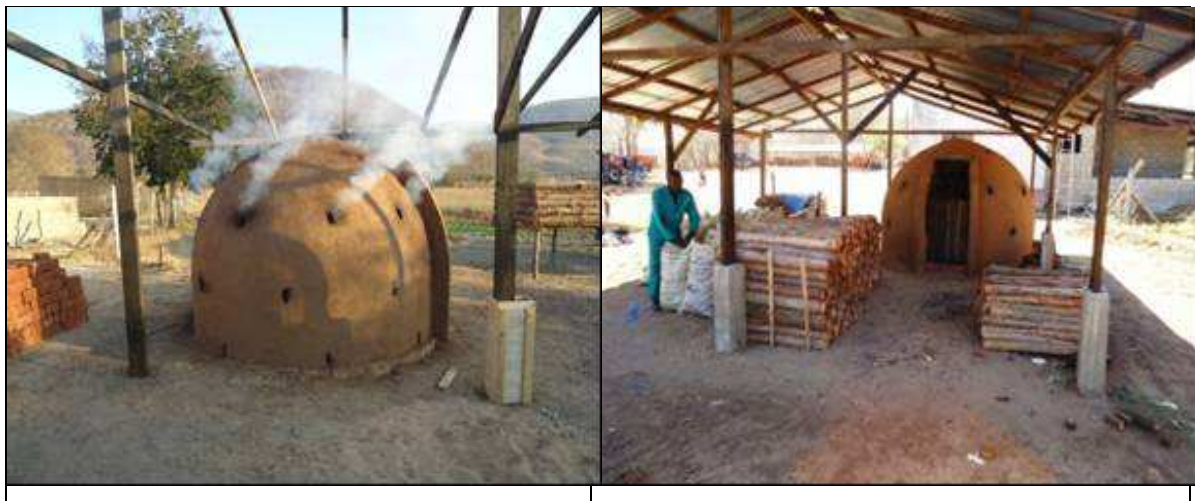
FIGURA 14: CONDUÇÃO DO PROCESSO DE CARBONIZAÇÃO DO FORNO FIXO TIPO RABO-QUENTE
