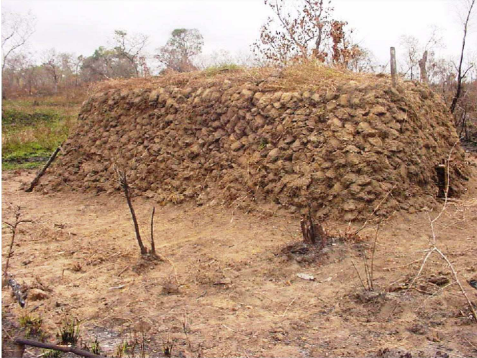
FIGURA 3: PROCESSO DE PRODUÇÃO DE CARVÃO VEGETAL EM FORNO TRADICIONAL DO TIPO MEDA USUAL EM MOÇAMBIQUE
