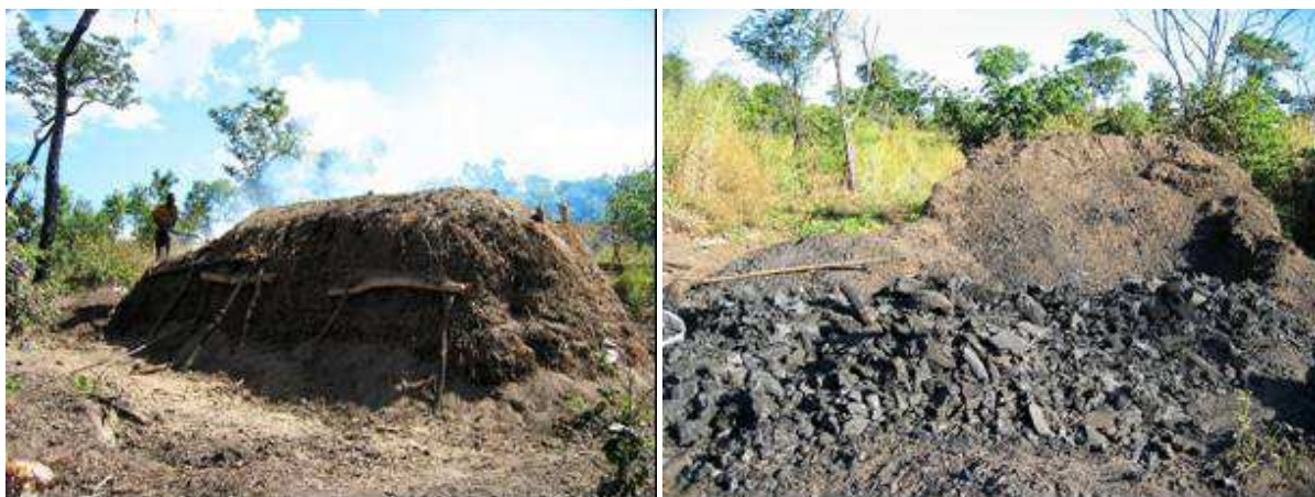
FIGURA 4: PROCESSO DE PRODUÇÃO DE CARVÃO VEGETAL EM FORNO TRADICIONAL DO TIPO CUPIM
