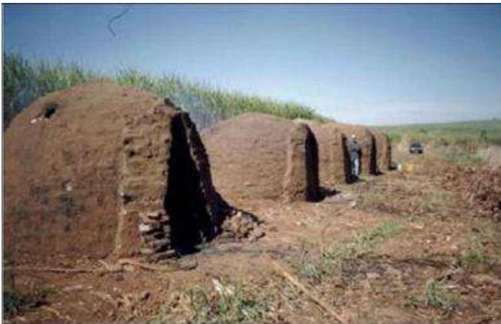
FIGURA 5: PROCESSO DE PRODUÇÃO DE CARVÃO VEGETAL EM FORNO DE ALVENARIA FIXO DO TIPO RABO-QUENTE
