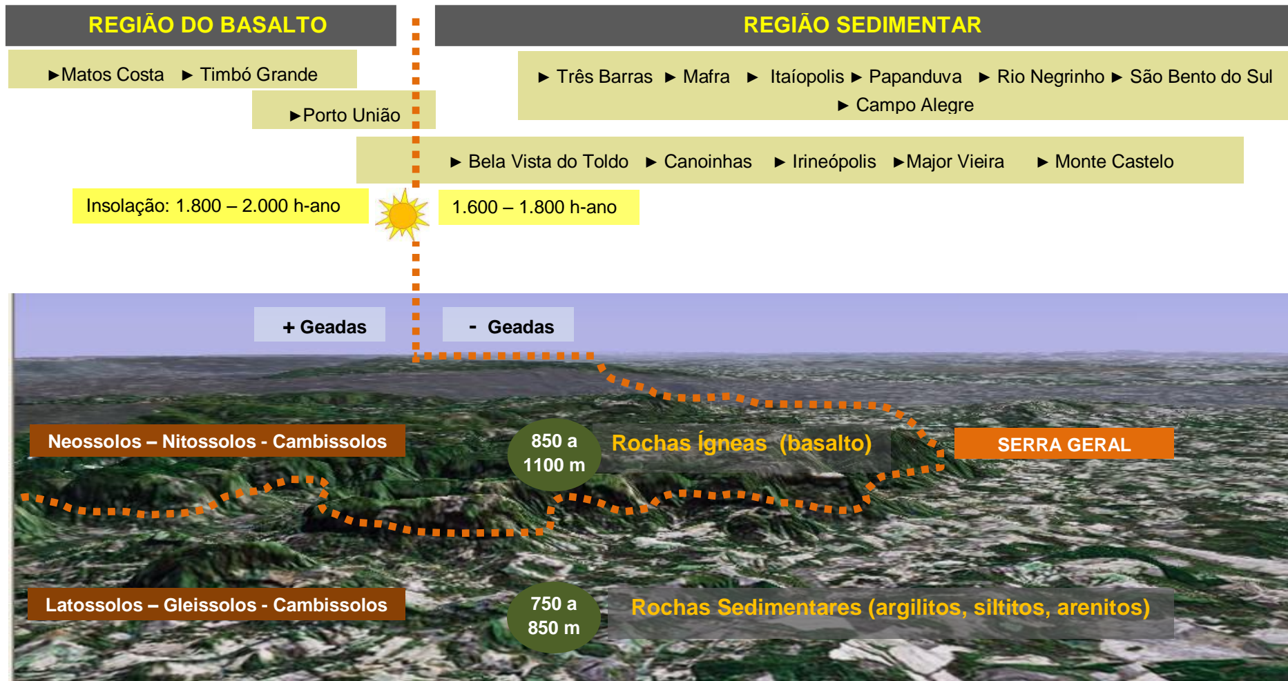
FIGURA 5.4 – CARACTERIZAÇÃO FÍSICA GERAL DAS REGIÕES SEDIMENTAR E DO BASALTO DO PLANALTO NORTE CATARINENSE. FONTE: elaborada pelo autor (Imagem Google Earth).
