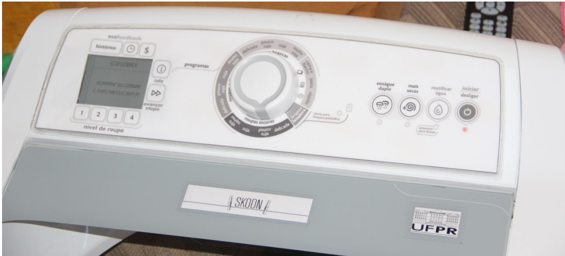
Figura 3. 8: Carenagem do painel de controle adaptado para funcionamento do eco-feedback . Fonte: SKOON (2013).
