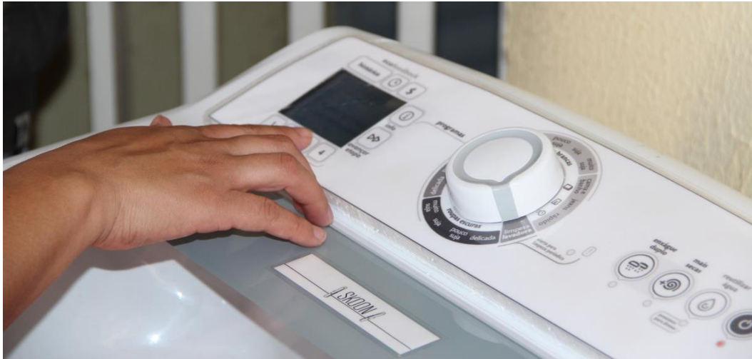
Figura 4. 58: Interface da lavadora adaptada para avaliação do eco-feedback (mockup) . FONTE: SKOON (2013).
