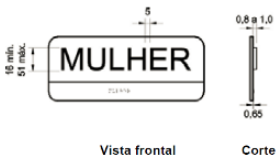
Figura 20: Sinalização Tátil Fonte: NBR 9050(2004)
