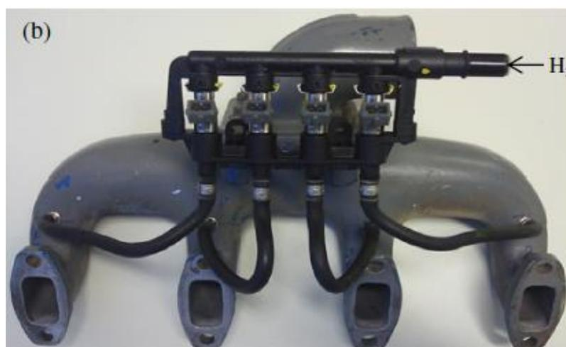
**FIGURA 7.** Sistema de injeção de hidrogênio em motores diesel acoplado ao coletor de admissão. Morais (2013)
