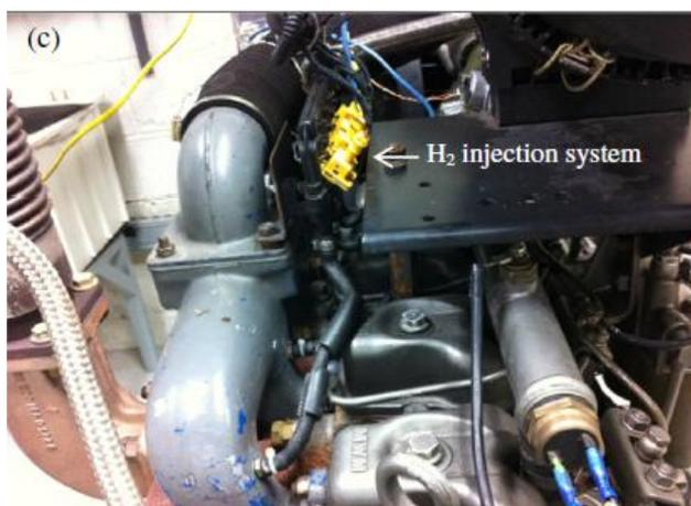
**FIGURA 8.** Sistema de injeção de hidrogênio acoplado ao motor diesel. Morais (2013)
