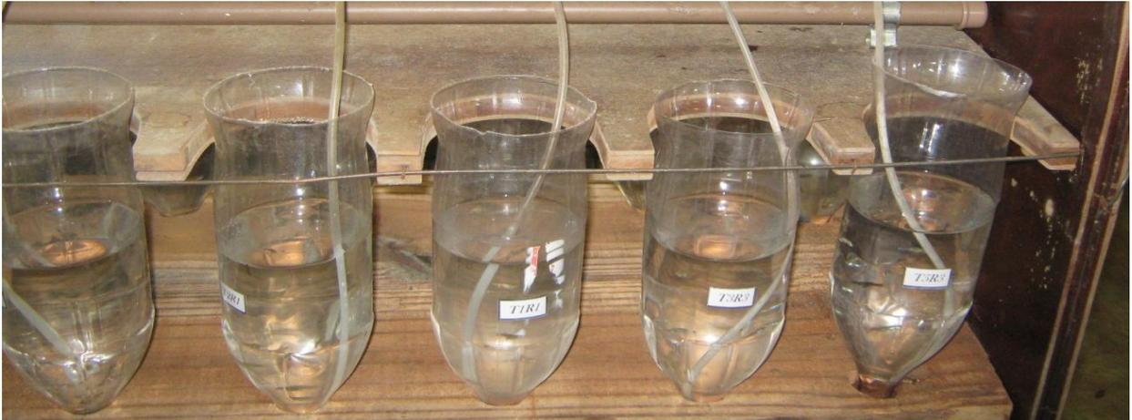
**Figura 6.** Sistema utilizado para a realização do experimento, com as unidades supridas com aeração e fotoperíodo controlado.
