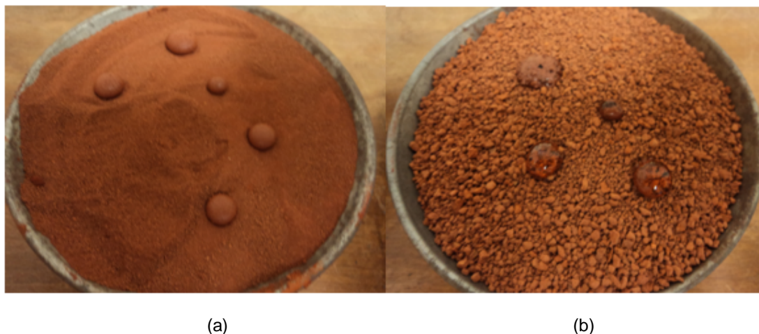
FIGURA 4.1 – ENSAIO WDPT PARA DIFERENTES GRANULOMETRIAS (a) MENORES DE 0,48mm (b) ENTRE 0,48mm E 2,0mm – TEMPO = 0h
