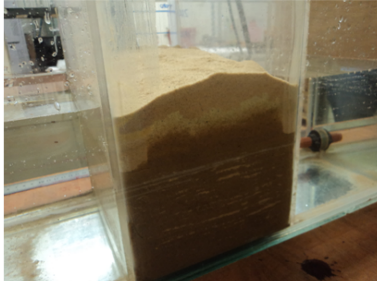
FIGURA 4.27 – INFILTRAÇÃO NA AREIA TRATADA PELAS PAREDES DA CAIXA
