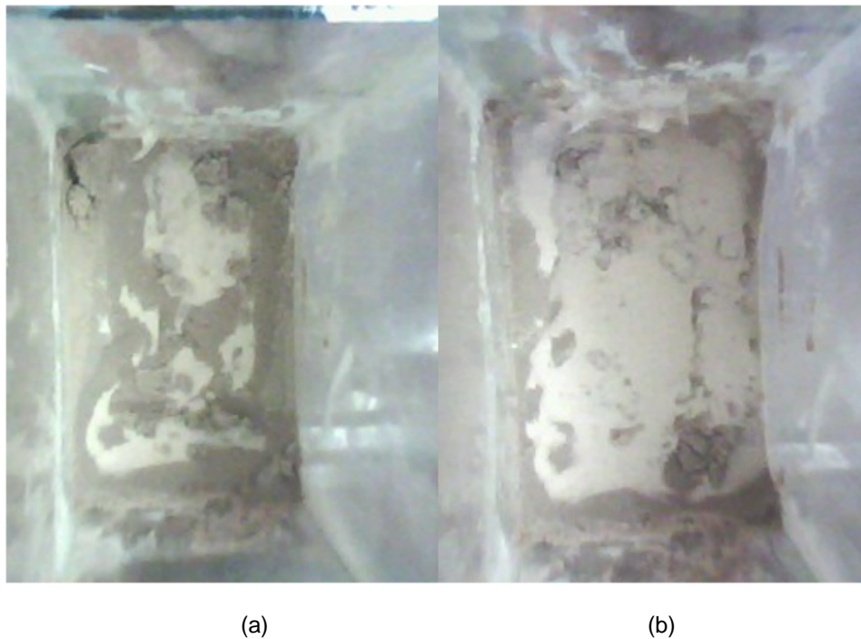
FIGURA 4.34 – VISTA SUPERIOR DA CAMADA DE AREIA TRATADA APÓS A QUEBRA DA BARREIRA (a) 1,5cm DA INTERFACE (b) 3,0cm DA INTERFACE
