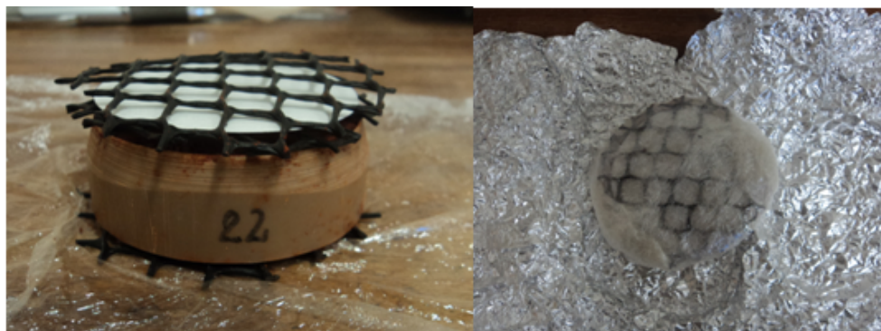
FIGURA 4.5 – POSICIONAMENTO DOS PAPÉIS FILTRO NA AMOSTRA E PROCEDIMENTO DE EMBALAGEM
