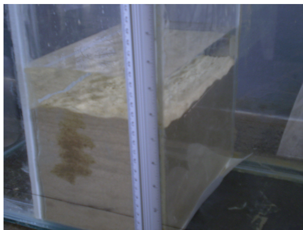
FIGURA 2.18 - FLUXO PREFERENCIAL NO CONTATO SOLO-LÍQUIDO NA DETERMINAÇÃO DE VALOR DE ENTRADA DE ÁGUA
