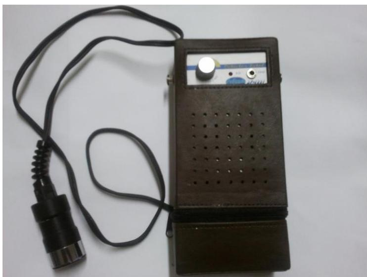
FIGURA 6 – SONAR DOPPLER UTILIZADO NA CAPTAÇÃO DO SOM DA DEGLUTIÇÃO
