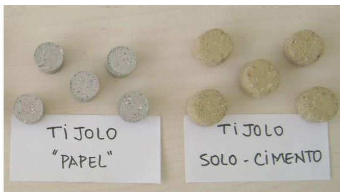
Figura 10 - Corpos de prova do bloco de vedação desta pesquisa e blocos de vedação de solo-cimento.
