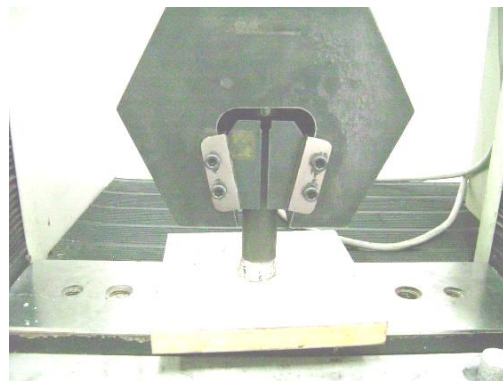
Figura 9 - Amostra no final do esmagamento na máquina de compressão.
