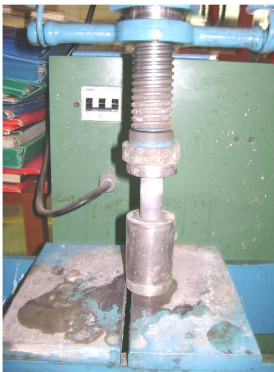
Figura 5- Mistura de lodo de papel, cinza de madeira e cal após prensagem.
