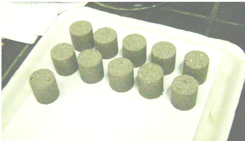
Figura 6- Corpos de prova moldados com dimensão de 20mm x 20mm.
