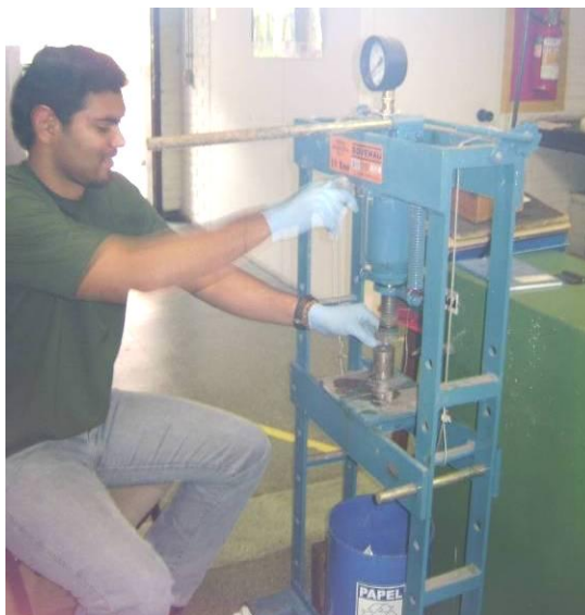
Figura 4 - Prensagem da mistura de lodo de papel, cinza de madeira e cal.
