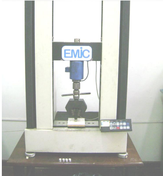
Figura 7 - Ensaio de compressão simples em MPa dos corpos de provas conforme NBR-5738/03.
