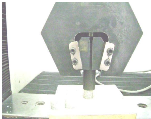
Figura 8 - Amostra no início do esmagamento na máquina de compressão.
