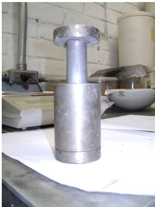
Figura 3 - Molde para prensagem da mistura de lodo de papel, cinza de madeira e cal.
