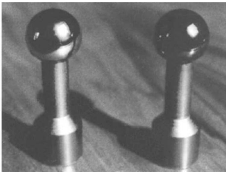
Figura 20: esferas de próteses de quadril revestidas com DLC (DORNER *et al.*, 2001).
