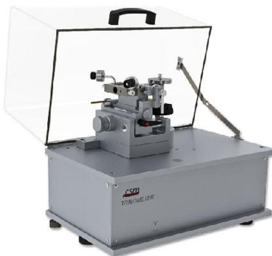
Figura 31: Equipamento utilizado nos ensaios - Tribômetro Linear Recíproco.
