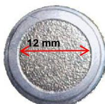
Figura 28: Amostra de Ti6Al4V + SMAT 15 min
