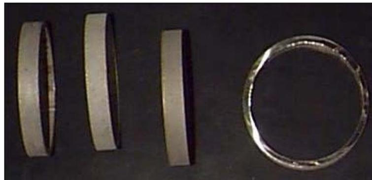
**FIGURA 31.-** Anéis de aço inoxidável austenítico AISI 304 L.
