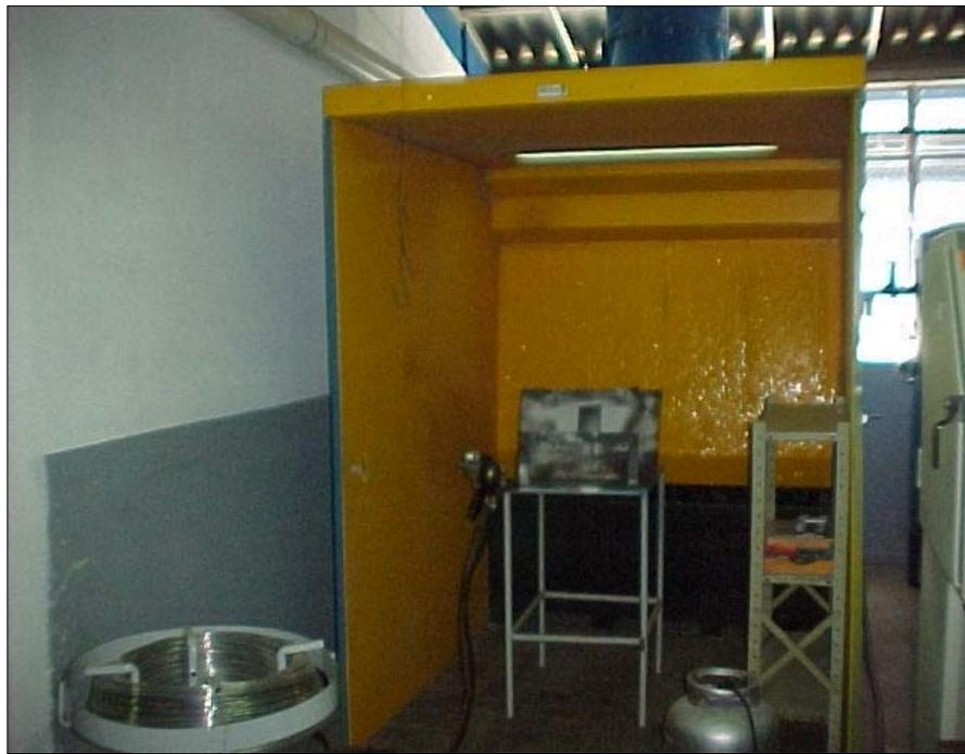
FIGURA 27.- Cabine com cortina de d'água .
