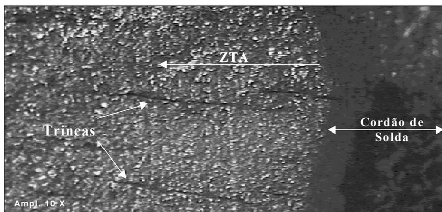
**FIGURA 43.-** Fotografia vista de cima da junta soldada, mostrando degradação avançada do cordão de solda e trincas na ZTA. Meio HCl 1N, T=70°C.
