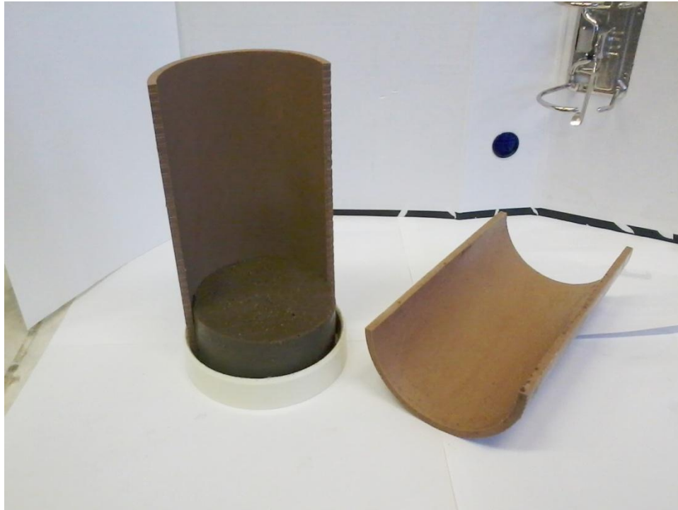
FIGURA 3.2. BIPARTIDO DE PVC E AMOSTRA DE SOLO-COLOIDE PRONTA PARA O CRAVAMENTO DO ANEL DE ADENSAMENTO.
