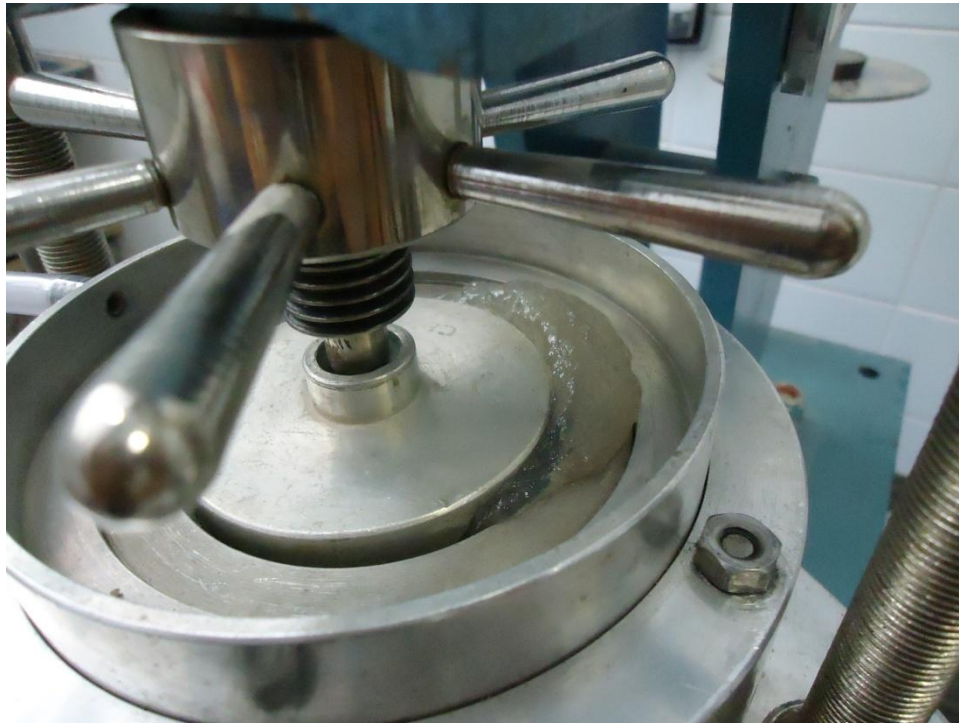
FIGURA 3.5. VAZAMENTO DE MATERIAL DO CORPO DE PROVA CAUSADO POR APLICAÇÃO DE CARREGAMENTOS MUITO GRANDES NO ENSAIO EDOMÉTRICO.
