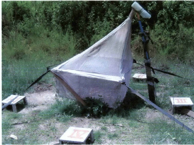
Fig. 1. Armadilha Shannon modificada sobre gaiola com Sus scrofa Linnaeus, 1758, instalada no Centro Politécnico, Curitiba, PR, de abril a setembro de 2005.
