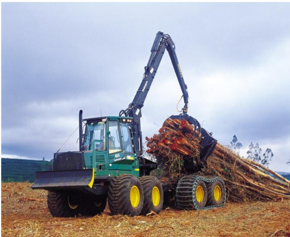
Figura 3 – Clambunk Skidder (extração na forma de arraste)
