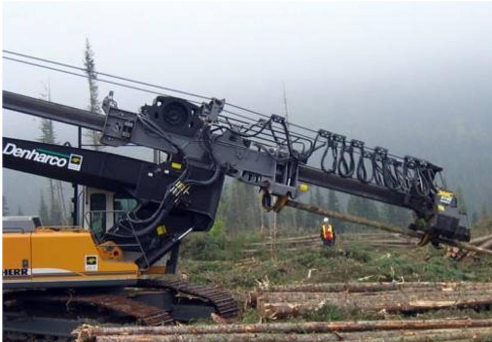
Figura 8 – Desgalhamento mecanizado utilizando *Delimber*
