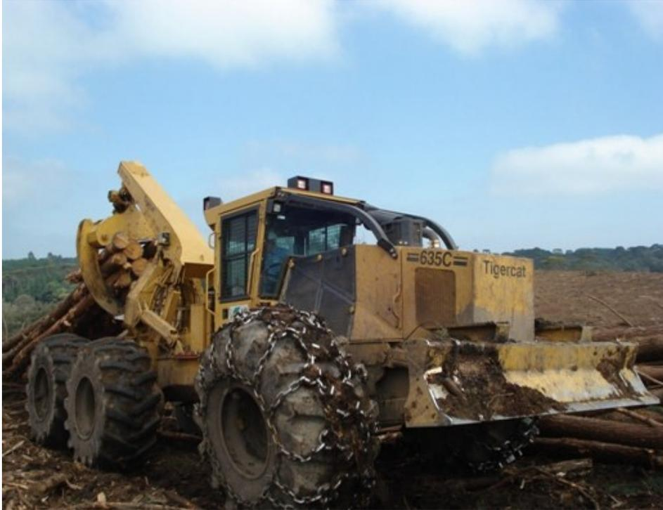
Figura 2 – Skidder de garra (extração na forma de arraste)
