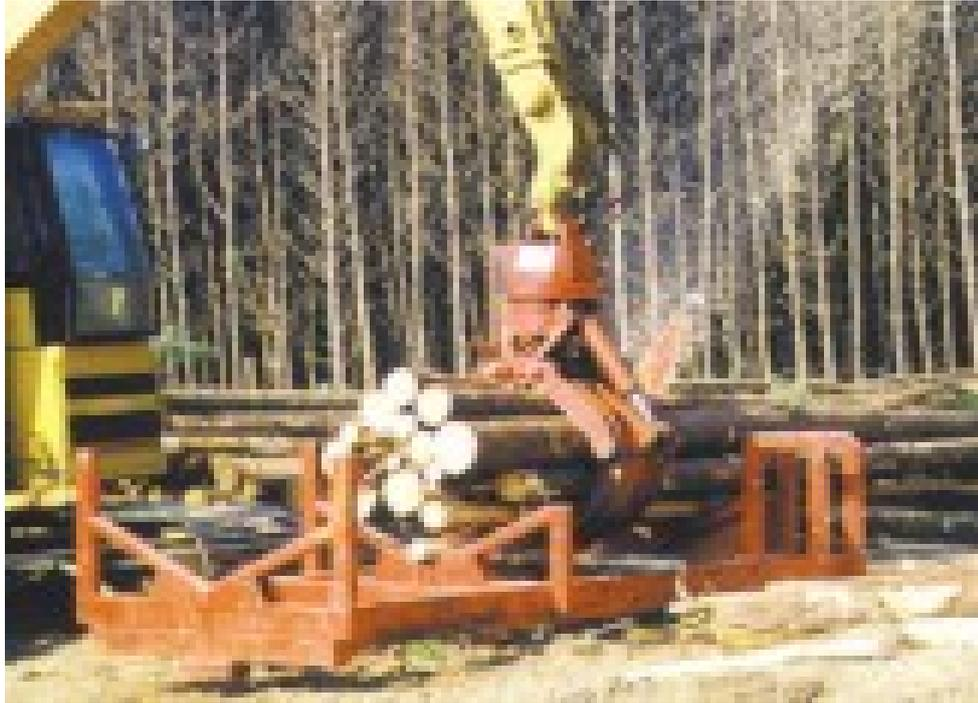
Figura 5 – Processador *Slasher* (processamento e carga)
