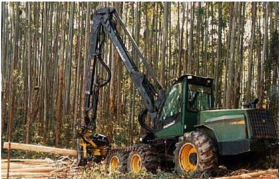
Figura 10 – *Harvester* (Abate, desgalhamento, processamento)
