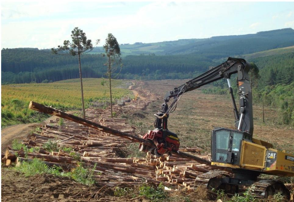
Figura 4 – Processador *Harvester* (desgalhe e processamento)
