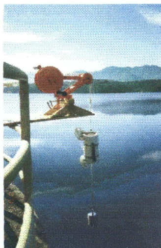
FIGURA 3 - MATERIAL USADO PARA A COLETA QUANTITATIVA DO FITOPLÂNCTON. GUINCHO COM CABO GRADUADO E MENSAGEIRO, PRANCHA, GARRAFA VAN DORN E PESO.
