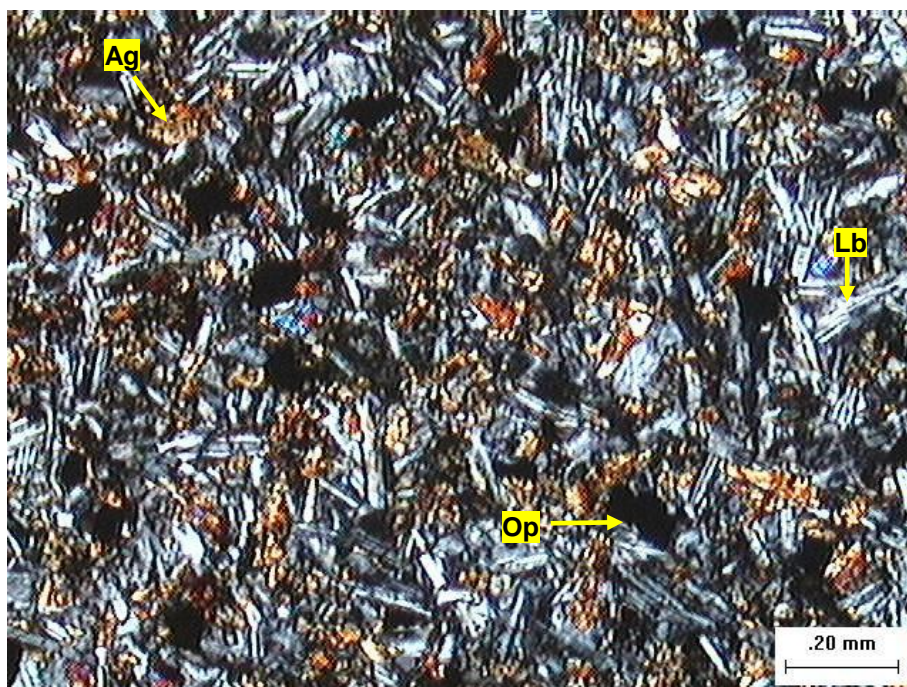
FIGURA 55 – FOTOMICROGRAFIA (LP) DA TEXTURA SUBAFÍRICA DO BASALTO DA PORÇÃO MEDIANA-INFERIOR DO NÍVEL MACIÇO CENTRAL. LABRADORITA (Lb), AUGITA (Ag) E MINERAIS OPACOS (Op)
