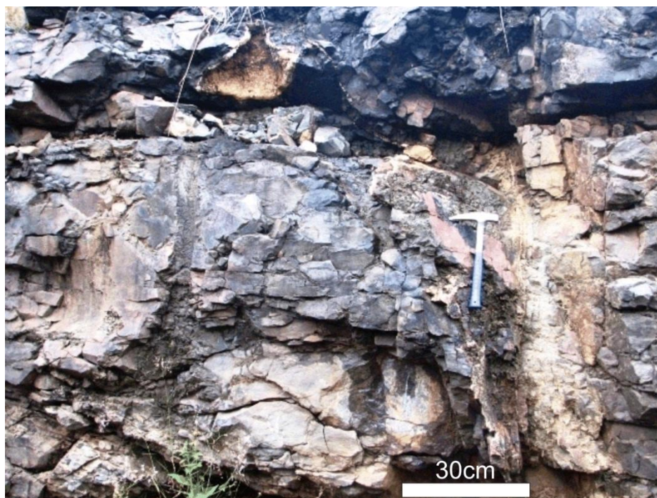
FIGURA 41 – FOTOGRAFIA DE ZONA DE CISALHAMENTO NA PORÇÃO MEDIANA-SUPERIOR DO NÍVEL MACIÇO CENTRAL
