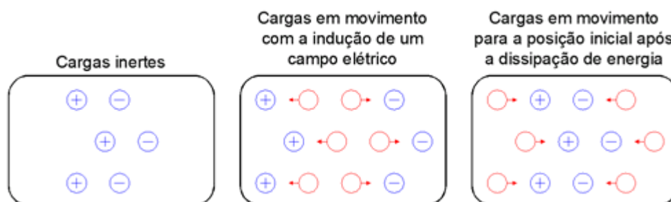
Figura 9 – Comportamento das cargas em função da aplicação de uma corrente de deslocamento (adaptado de Annan, 2001).
